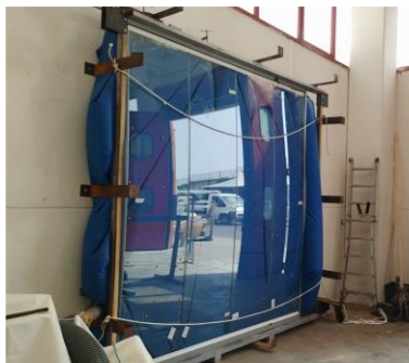
Campione durante la prova al vento
