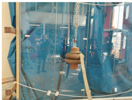
Campione durante la prova d'impatto
